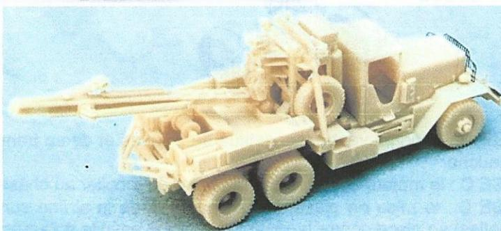
**PHASE I :** elle concerne la flèche. Attention au sens des supports, le renfort triangulaire doit être orienté vers le haut. Coller la pièce sur la poulie et l'ensemble sur la flèche.
